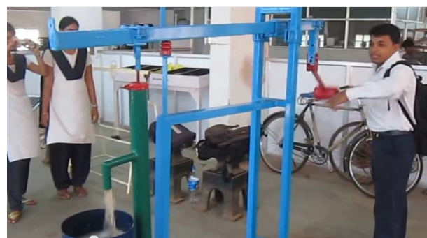
Slika 4. Replika ručne pumpe za vodu sa klatnom iz Indije, Arun Sahoo, 2013. http://youtu.be/8n7mvpLpP5A
