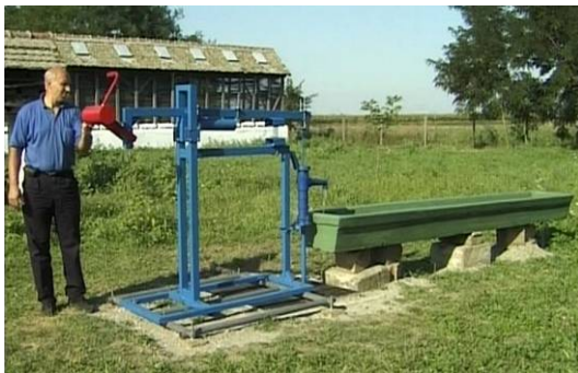
Slika 3. Ručna pumpa za vodu sa klatnom na terenu (okolina Novog Sada, avgust 2004.) http://youtu.be/hNpgI7o_1QI
