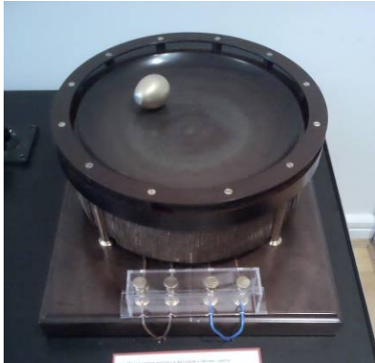
Slika 8. Teslin eksperiment „Kolumbovo jaje“ (indukcioni motor sa rotorom u obliku jajeta koje rotira u magnetnom polju) Muzej Nikole Tesle, Beograd
